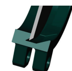
Etanchéité métal/métal / Tightness metal/metal
