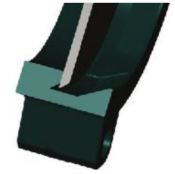
Etanchéité métal/métal Tightness metal/metal
