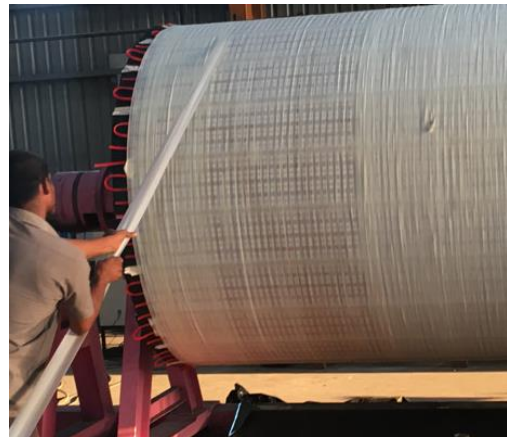
ยางหุ้มร้อนเซรามิค "Elastotec" นานา อายุใช้งานนานถึง 10 ปี เกาะยึดสายพานได้ดีที่สุด เรามีบริการหุ้มในไทยเป็นที่แรกและที่เดียว ไม่ต้องส่งไปหุ้มที่ต่างประเทศ
