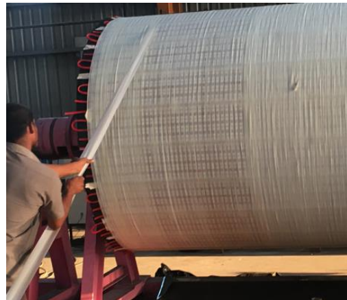
ยางหุ้มร้อนเซรามิค "Elastotec" นุ่มาน อายุใช้งานนานถึง 10 ปี เกาะยึดสายพานได้ดีที่สุด เรามีบริการหุ้มในไทยเป็นที่แรกและที่เดียว ไม่ต้องส่งไปหุ้มที่ต่างประเทศ
