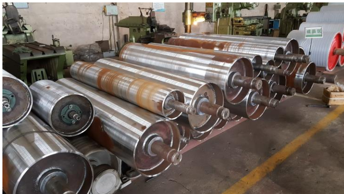
พุลลีย์ที่ประกอบเสร็จแล้ว
