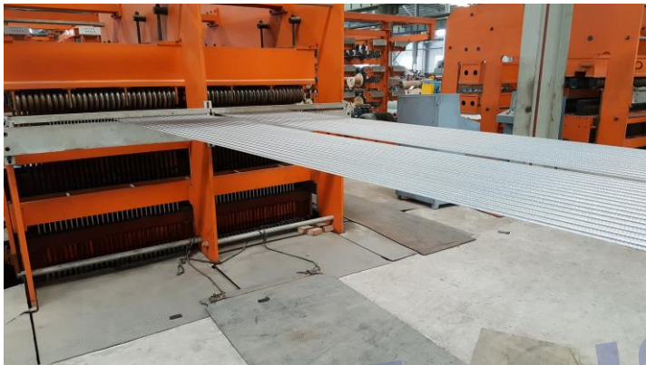
ไลน์การผลิตสายพาน steel cord
